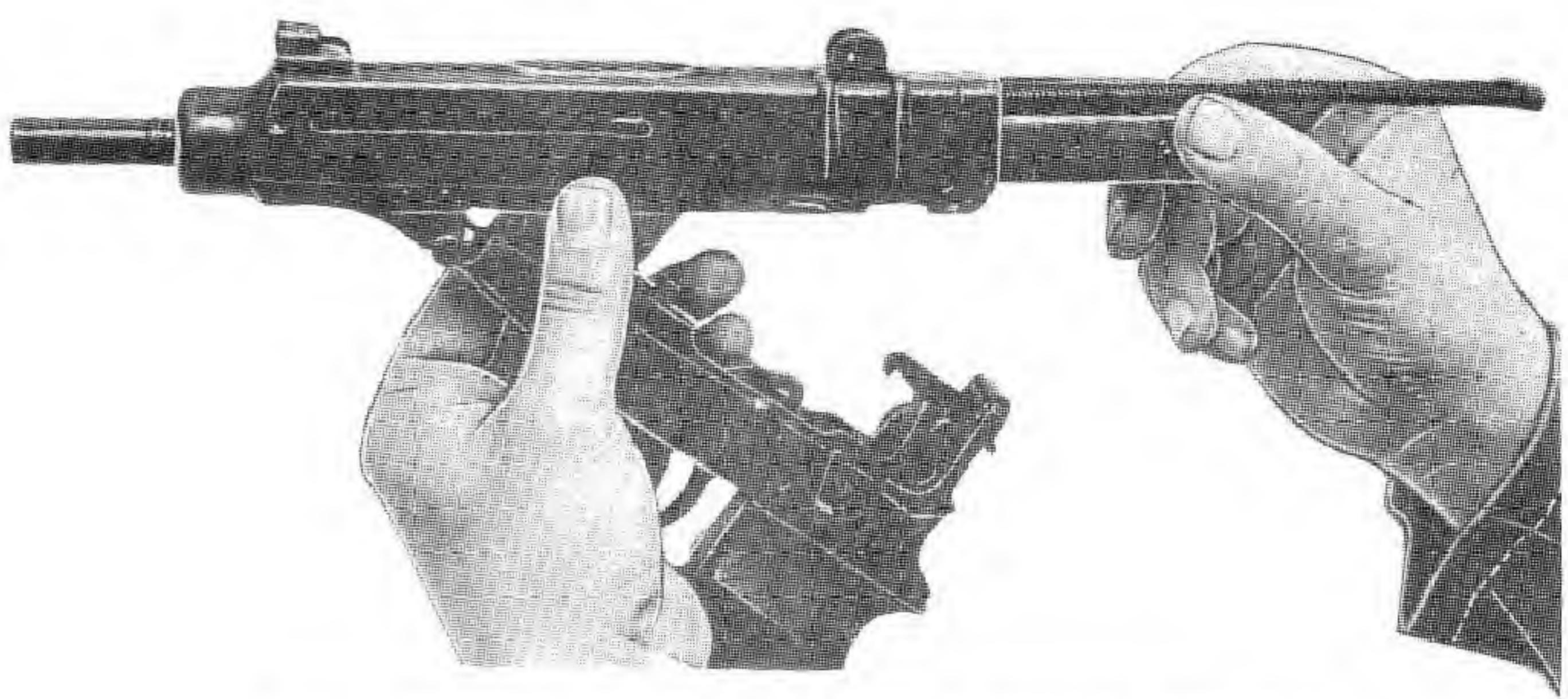
Sl. 54 – Odvajanje zatvarača od vođice zatvarača (pištolja)
